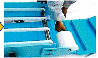
内蔵ドラムモータ 『防水仕様』 SUS被覆材にて保護
