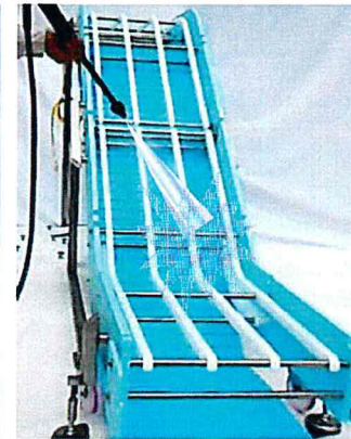
⑥洗浄開始…高圧洗浄機使用例 レールも簡単に脱着可能、汚れ状況で外して洗浄して下さい。
