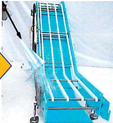
⑥洗浄開始…高圧洗浄機使用例 レールも簡単に脱着可能、汚れ状況で外して洗浄して下さい。
