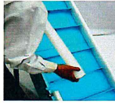
②サイドガイドの取り外し… 工具を使わず簡単に脱着が可能!
