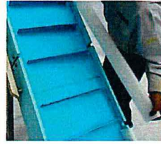
②サイドガイドの取り外し… 工具を使わず簡単に脱着が可能!
