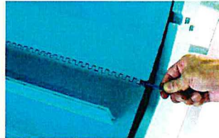
⑥洗浄開始…高圧洗浄機使用例 レールも簡単に脱着可能、汚れ状況で外して洗浄して下さい。
