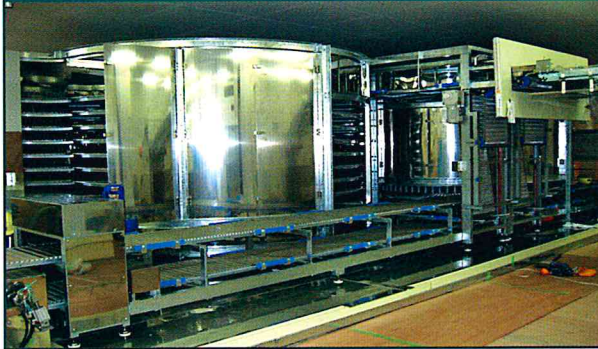
ベルトのクリーン化（高圧ノズル式洗浄機）
