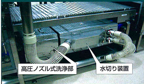
ベルトのクリーン化（高圧ノズル式洗浄機）
